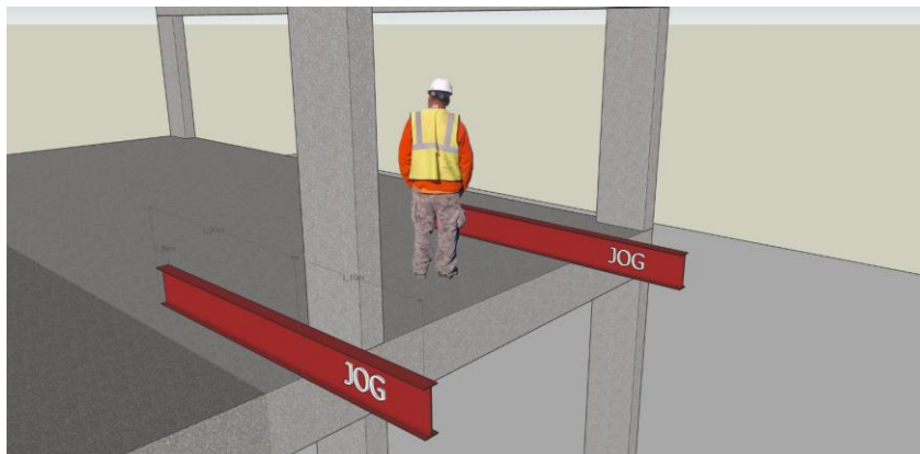
2 – Posicione as VMs e inicie a furação pelos box traseiros
